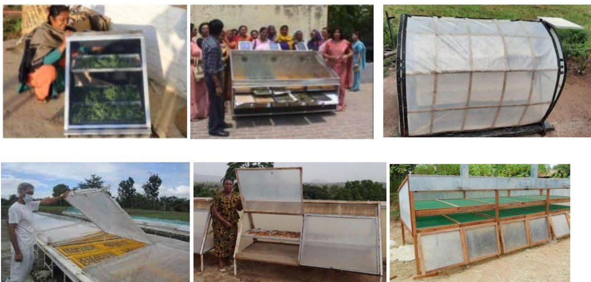
Secadores solares: modelo de gabinete de madera y vidrio (CRT, Nepal), gabinete de metal y vidrio (AIWC, India), modelo Poly-Tunnel de bambú (INSEDA, India) y modelos semiindustriales (PHilMech) en Filipinas y ESFRITA & TaTEDO en Tanzania.
