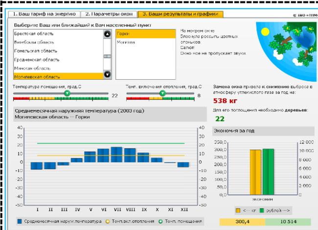
Электронный калькулятор «Окна» для расчета эффективности установки энергосберегающих окон (три вкладки)
